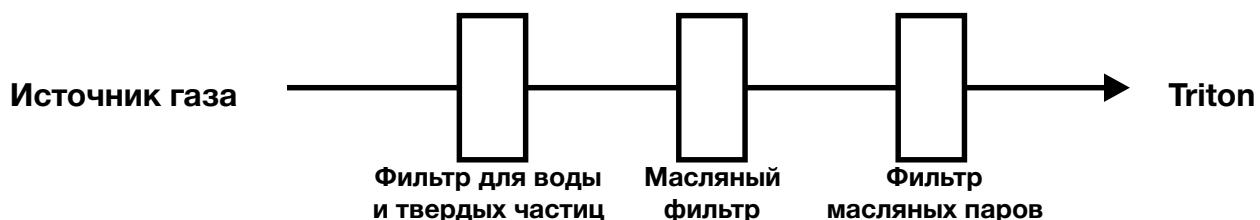
Система фильтрации должна быть установлена между источником газа и источником тока. Для дополнительной фильтрации газа может потребоваться более высокое давление из источника.
