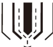
Плазмо-образующий газ |
