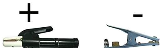
ПОЛОЖЕНИЕ ЭЛЕКТРОДА ПРИ СВАРКЕ
