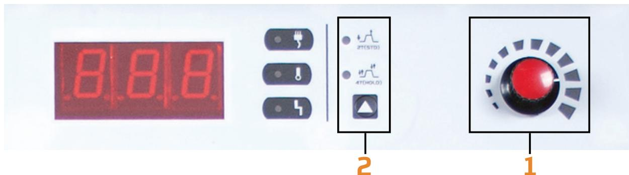
**1** С помощью ручки установите ток плазменной резки
